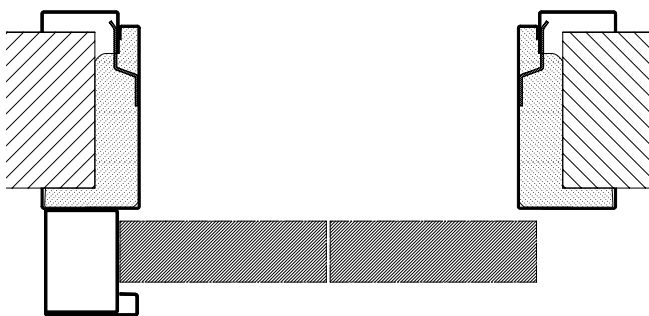
Schiebetürzarge in der Wand laufend, dichtschließend
